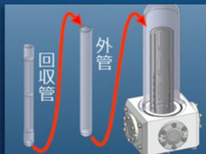
材料の回収やガラス管の交換が簡単に行えます
